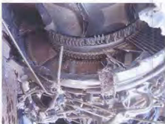
1.3.2. Evidencias que el motor izquierdo estaba trabajando al momento del impacto
