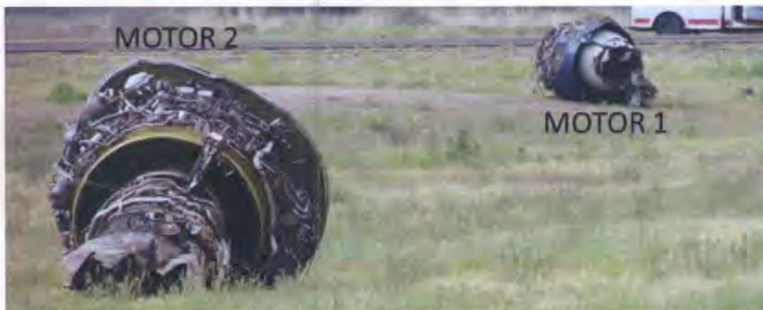
1.3.1. motores desprendidos de su ubicación de diseño (semialas de la aeronave) por impacto
