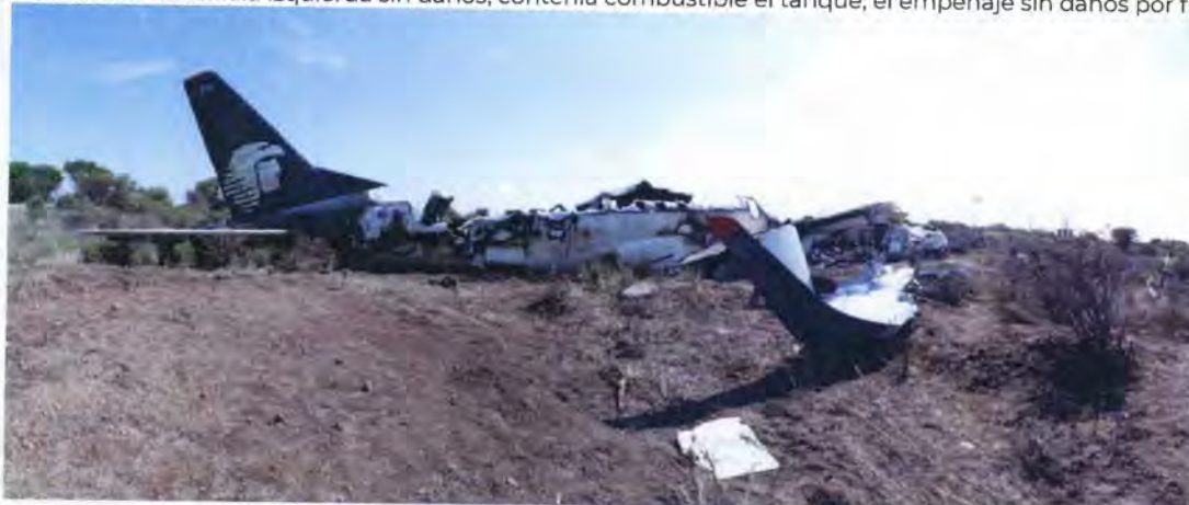
1.3.5. Vista desde la semiala derecha con daños y sin combustible en el tanque, el empenaje sin daños por fuego
