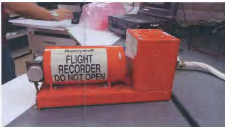
1.10.1.1. condiciones externas de DVDR instalado en la parte delantera de la aeronave se recuperó sin daños
