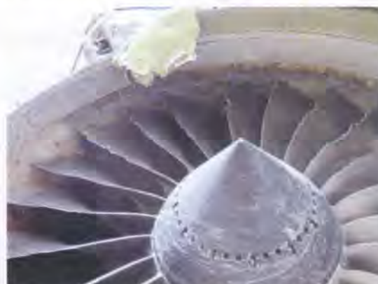
1.3.3. Evidencias que el motor derecho estaba trabajando al momento del impacto
